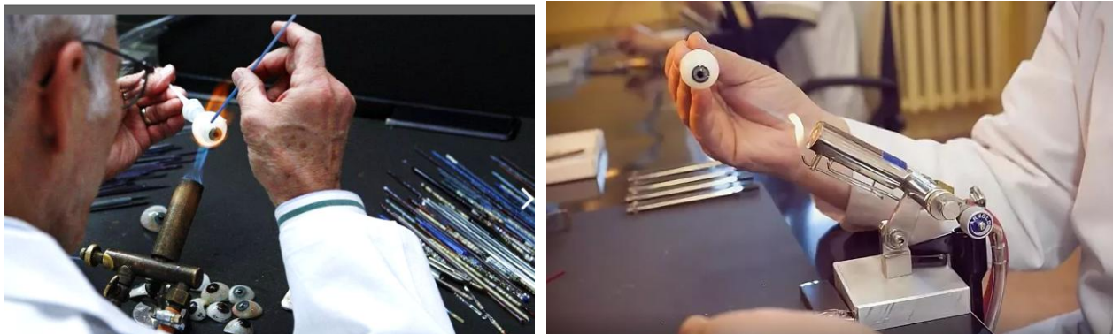
Рис. 1. Газовая горелка для выдувания глазного протеза
