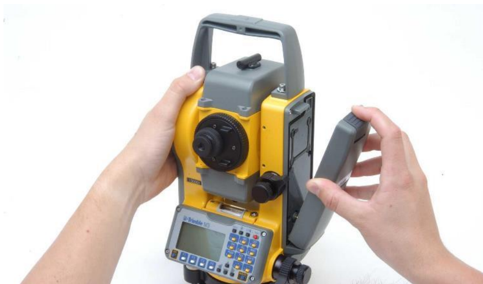
Рис. 2. Отсоединение и присоединение батареи к электронному тахеометру Trimble M3
