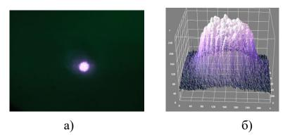
Рис. 9. a) фото лазерного пятна; б) распределение интенсивности излучения в сечении лазерного пучка, построенное при помощи программы ImageJ
