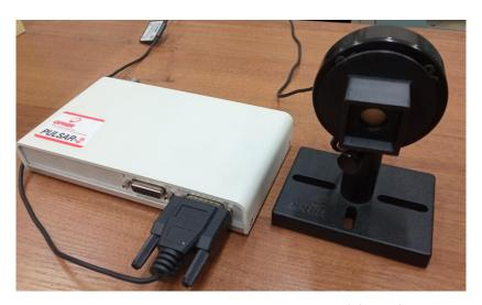
Рис. 5. Измеритель мощности Ophir Pulsar
