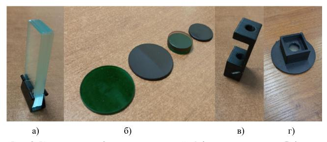
Рис. 3. Комплект светофильтров с оснасткой: а) фильтры для лазера; б) фильтры для камеры; в) оснастка для фильтров; г) оснастка с фильтрами для измерителя мощности
