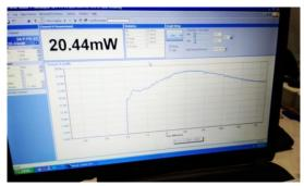
Рис. 8. Картина измерений средней мощности ИК-лазера в режиме реального времени
