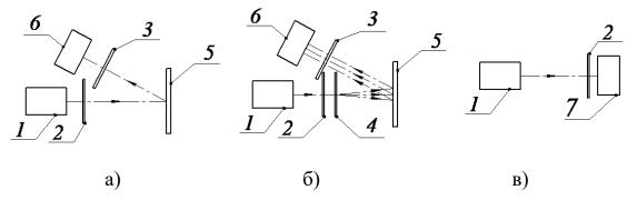
1 – лазер; 2, 3 – фильтры для лазера и камеры; 4 – дифракционная решетка; 5 – экран; 6 – камера; 7 – измеритель мощности.
