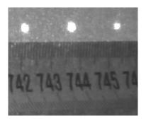
Рис. 7. Дифракционная картина излучения ИК-лазера, прошедшего сквозь дифракционную решетку
