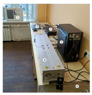
Рис. 1. Лазерный лабораторный комплекс. 1 — блок охлаждения, 2 — драйвер AOM, 3 — драйвер лазера, 4 — лазерный излучатель, 5 — компьютер, управляющий AOM, 6 — монтажная плита для установки модулей различных лабораторных работ.
