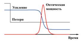
Рис. 2. Временная эволюция усиления и потерь в лазере с активной модуляцией добротности
