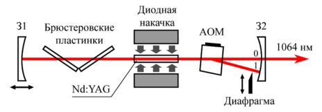
Рис. 4. Резонатор лазерного излучателя
