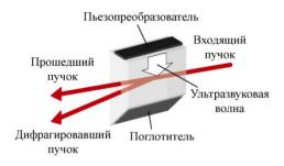
Рис. 3. Принцип работы АОМ
