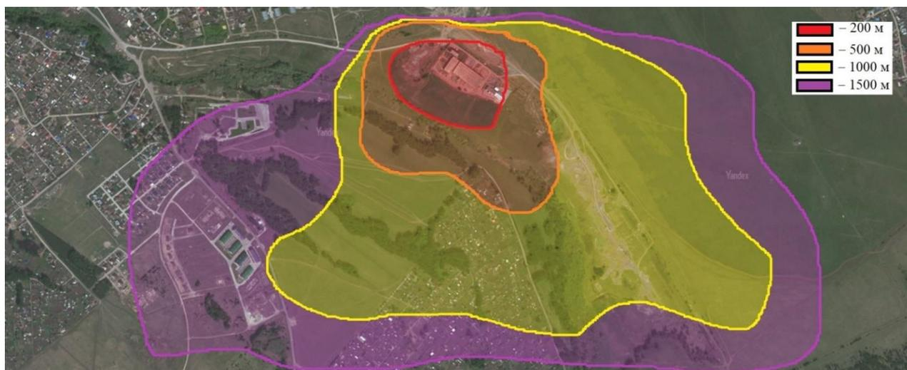
Рис. 7. Распространение вредных веществ в атмосфере в радиусе полутора километров от завода
