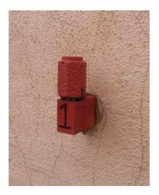
Рис. 2. Осадочная марка с защитным колпачком
