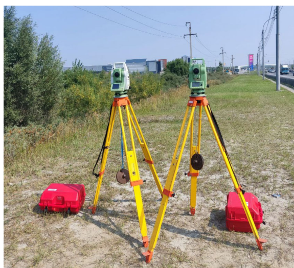
Рисунок 10 – Схема установки эталонного и поверяемого тахеометров
