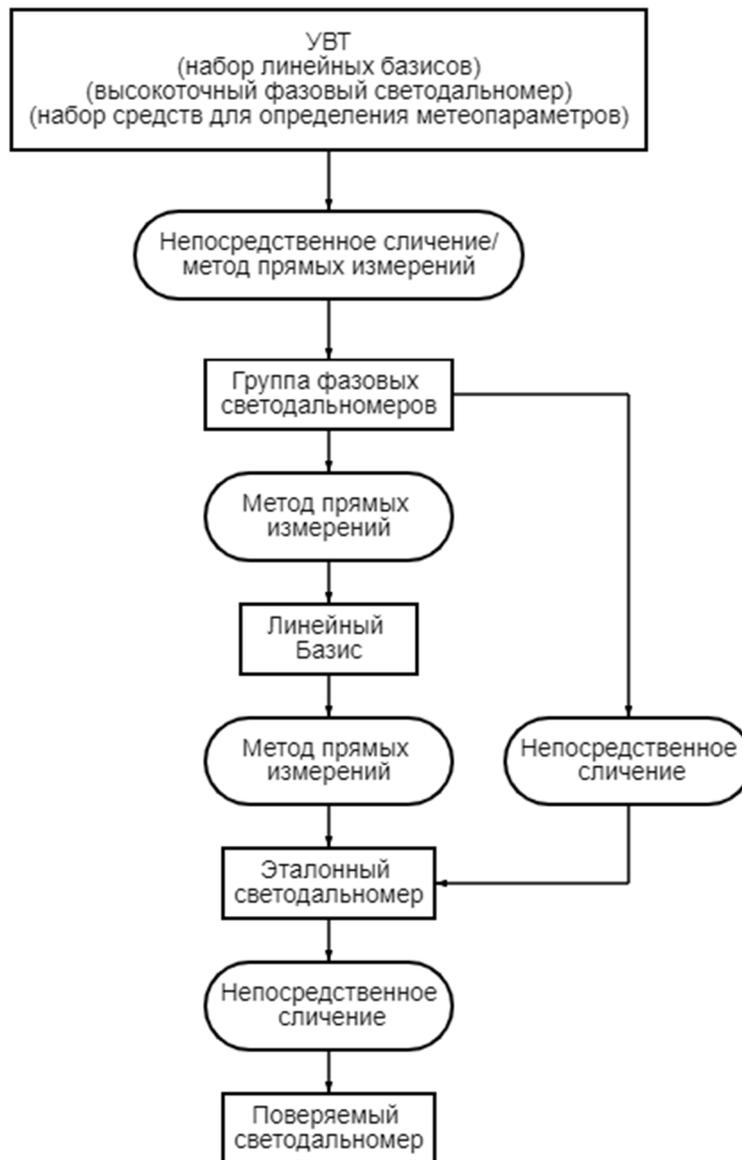
Рисунок 2.9 – Последовательность (этапы) передачи размера единицы длины
