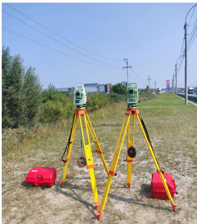
Рисунок 3.12 – Схема установки эталонного и поверяемого тахеометров
