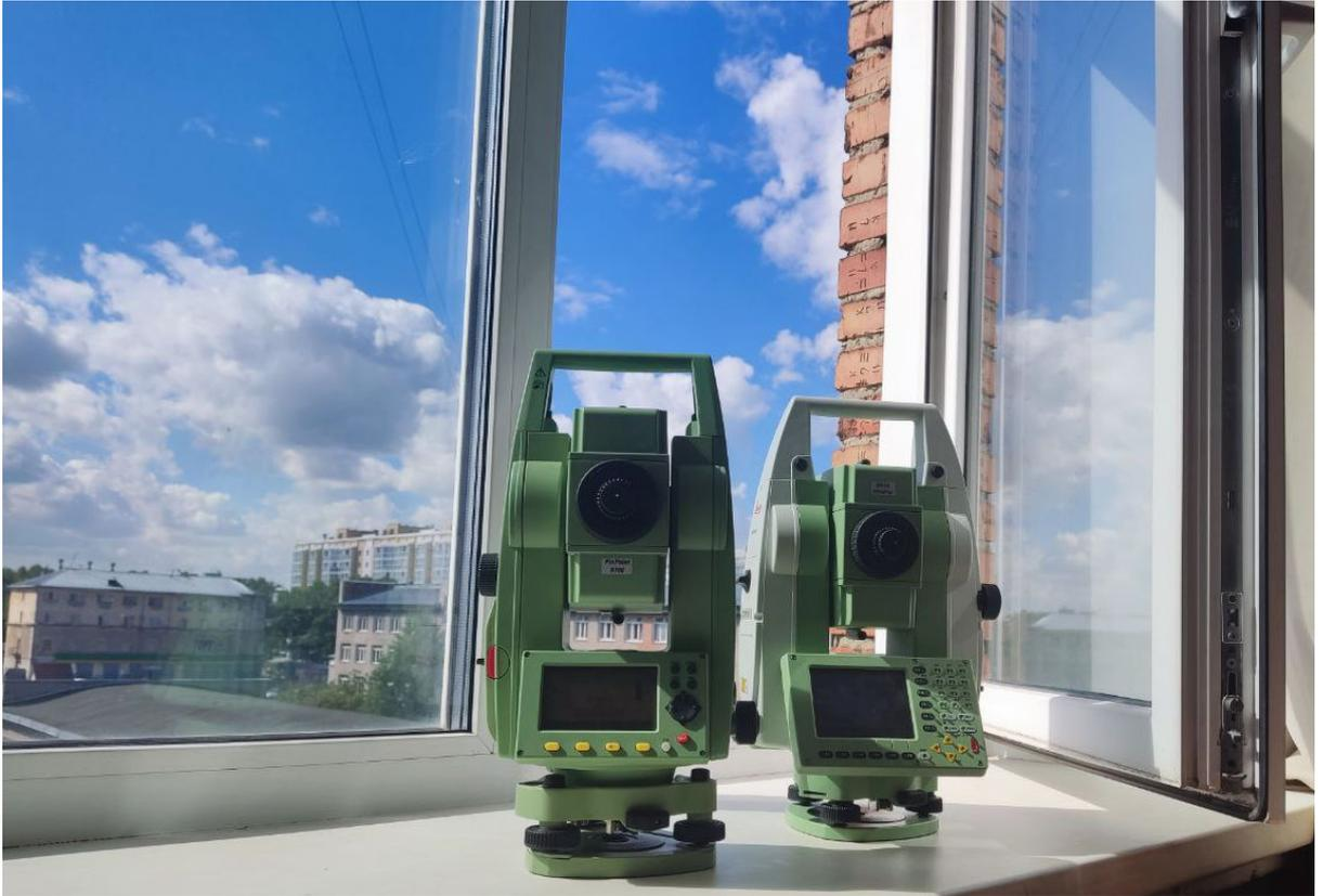
Рисунок 2.20 – Схема установки тахеометров на подоконник
