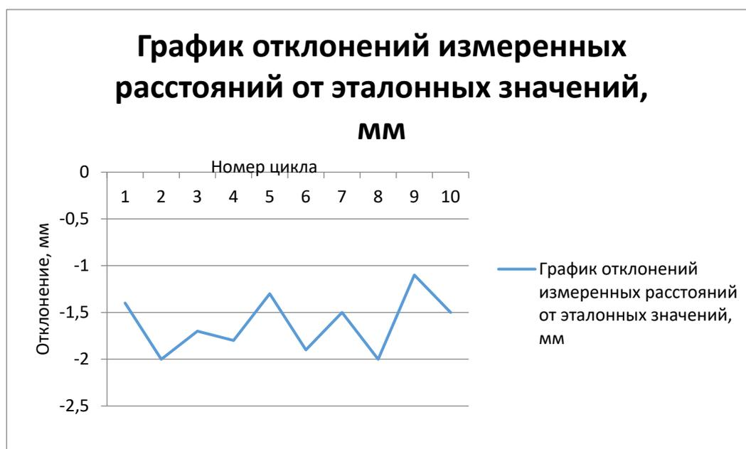
Рисунок 2.14 – График отклонений измеренных расстояний от эталонных значений
