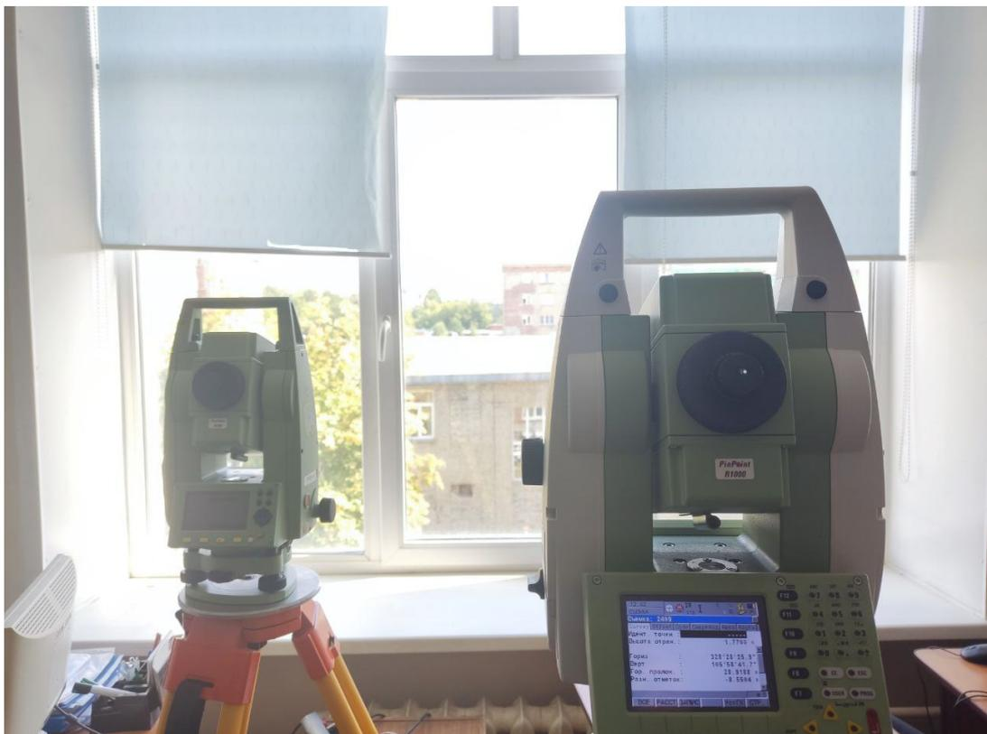
Рисунок 2.21 – Схема установки тахеометров на штативы
