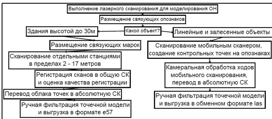
Рисунок 6 – Схема проведения работ по лазерному сканированию для задач 3D-кадастра
