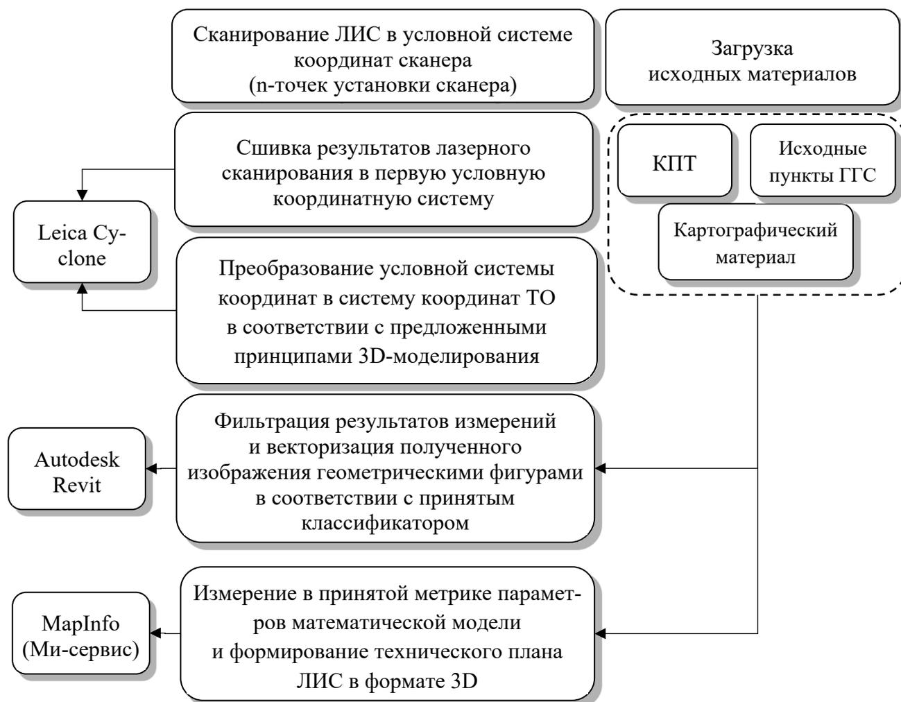
Рисунок 2 – Алгоритм формирования 3D-модели и технического плана ЛИС
