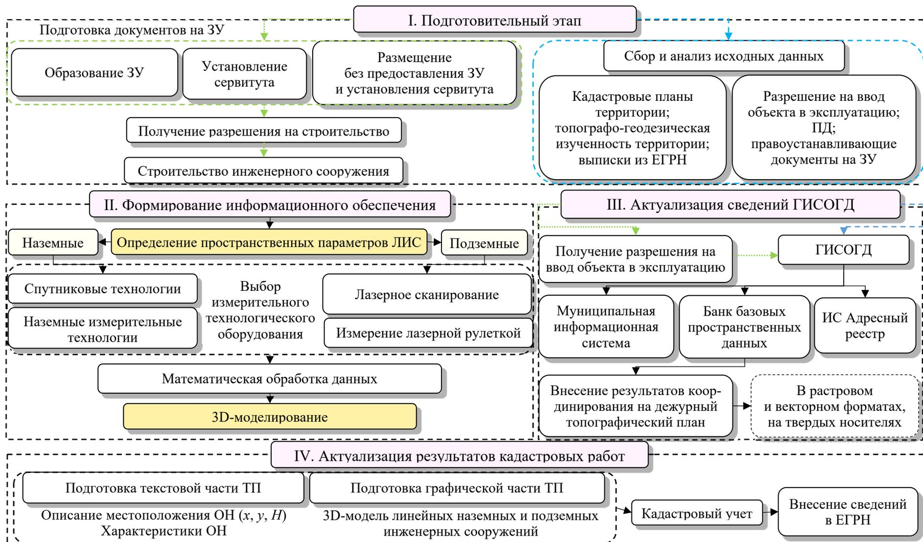
Рисунок 1 – Методика информационного обеспечения кадастровых работ в отношении линейных наземных и подземных инженерных сооружений
