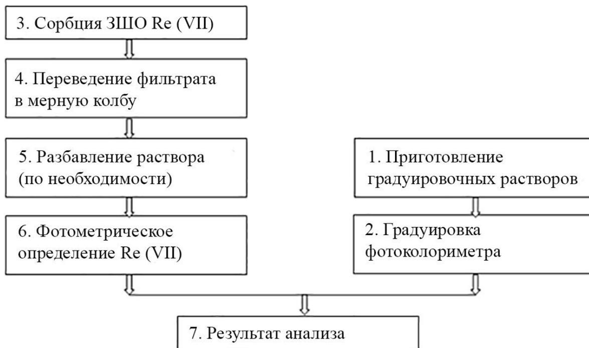
Рис. 1. Методика сорбционно-фотометрического определения рения в сернокислых растворах медно-молибденитового производства
